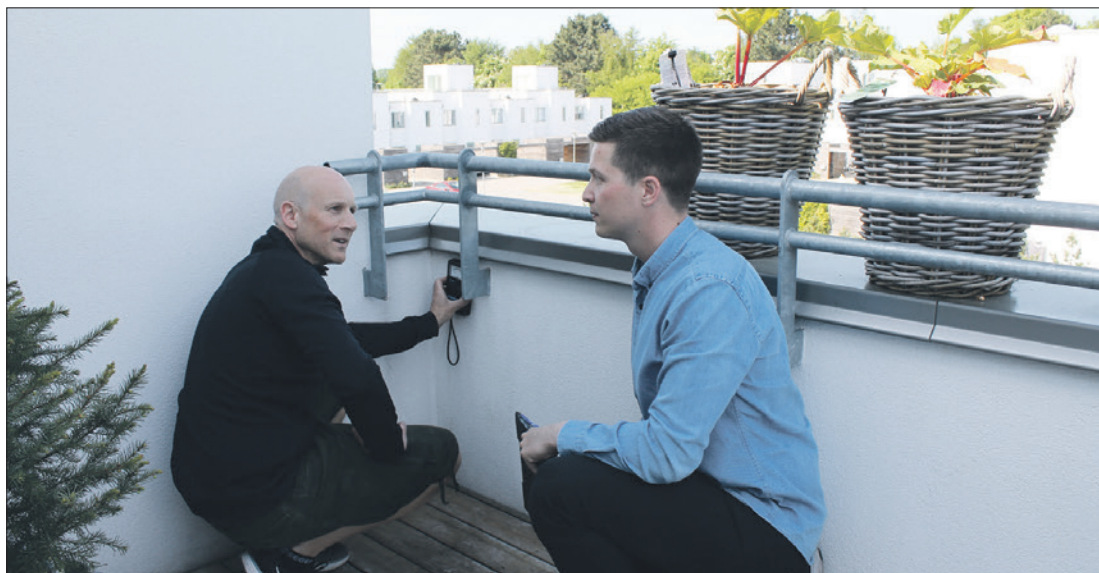
På terrassen ud for 3. sal bliver væggene også undersøgt for om der er trængt fugt ind bag pudset.
